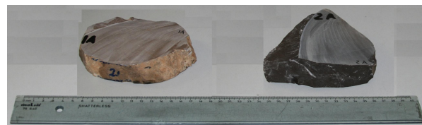
Figure 7. Echantillons pris en surface, 1A : calcaire du Carixien, 2A : calcaire du Bajocien supérieur.
